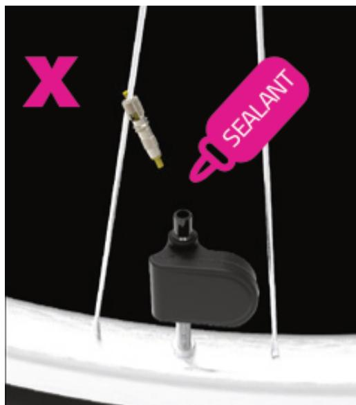
Fülle das Reifendichtmittel nicht durch das Sensorventil, ohne den Sensor und die Ventileinheit zu entfernen..
