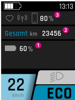
1. Ladestand der Batterie (Falls mehrere Batterien vorhanden sind, werden diese angezeigt und entsprechend durchnummeriert.)
