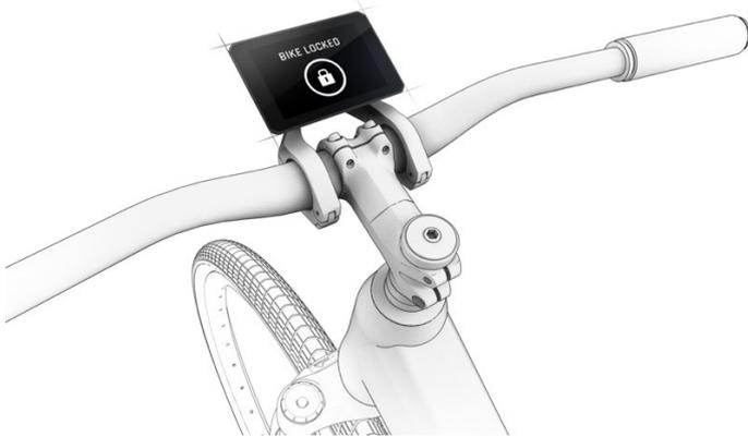
Display als Schlüssel – durch die Entnahme wird der Motor verriegelt und das E-Bike kann nicht mehr mit Unterstützung gefahren werden.
