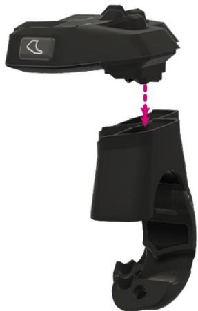
⑤ Remote mit den neuen Schrauben (M3x10) wieder an der Halterung festschrauben (0.5Nm).
