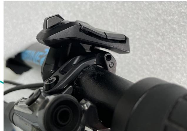
Bei manchen Bremsen kann die Klemmschelle der Bremsen mit der Unterseite der Remote Basic in Kollision geraten, wenn die Bremse steiler angestellt werden soll. Um dies zu vermeiden haben wir ein Distanzstück erstellt, welches den Abstand vergrößert und so den Freiraum für eine individuelle Bremseinstellung zulässt:
