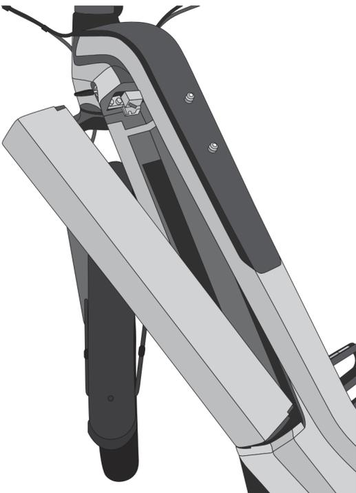
2. Déplace-le avec la partie supérieure vers le vélo électrique jusqu'à ce que le cadenas s'enclenche de manière audible dans le support supérieur.
