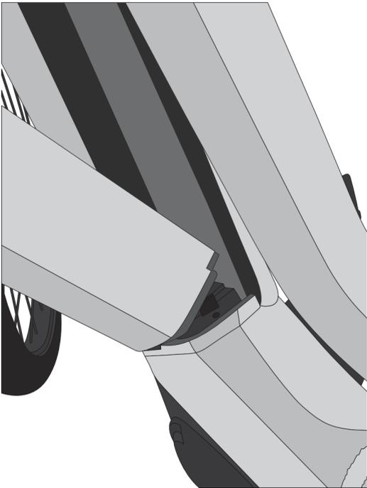
1. Introduis d'abord la batterie dans le support inférieur du vélo électrique.
