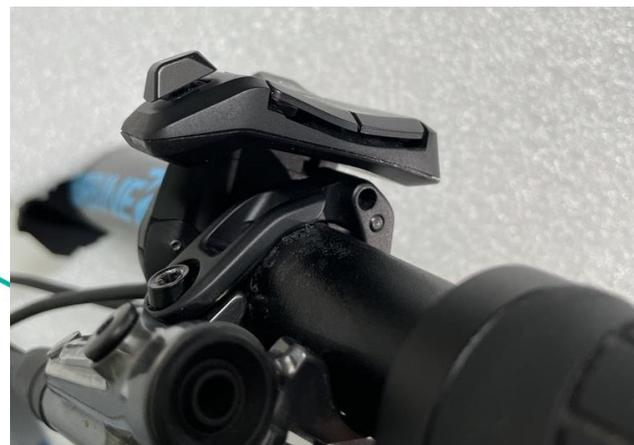
Con alcuni freni, la pinza dei freni può collidere con la parte inferiore del Remote Basic se il freno deve essere applicato più ripidamente. Per evitare questo, abbiamo creato un distanziatore che aumenta la distanza e quindi permette lo spazio per la regolazione individuale del freno:
